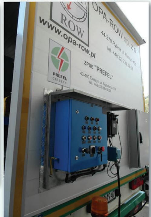
El elevador está situado en un remolque cerrado y preparado para cualquier condición atmosférica. El elevador móvil está diseñado para trabajar en atmosferas con bajo riesgo de explosión de gas y polvo.
