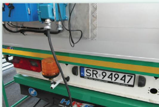
La unidad de control del freno hidráulico:
